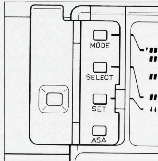
Die Aufzeichnungs-Betriebsart wird mit Hilfe des Betriebsartenknopfes "MODE" ein- und ausgeschaltet, während die Einstellung von Datum und Uhrzeit mit Hilfe der Wähl- und Einstellknöpfe "SELECT" und "SET" erfolgt. Der "ASA"-Knopf dient zur Wahl des Belichtungsmaßes für die Aufzeichnung auf den Film. Der Steuerknopfdeckel kann durch Hochheben am oberen Ende mit dem Fingernagel geöffnet werden.
