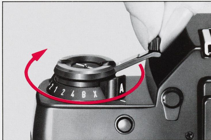
**6** フィルムカウンターが“1”を示すまで、フィルム巻上げとレリーズボタンを押す操作(空写し)を繰り返します。撮影はカウンターに“1”が出てから始めてください。巻上げ時に巻戻しノブ内のフィルム給送表示(白線)が回ればフィルムは正しく送られています。カウンターが“1”を示すまでの空写しでは、シャッターダイヤルがどの位置にセットされていても(Bは除く)、自動的に1/60秒でシャッターが切れる機構になっています。カウンター“1”からはセットしたシャッター速度で作動します。
