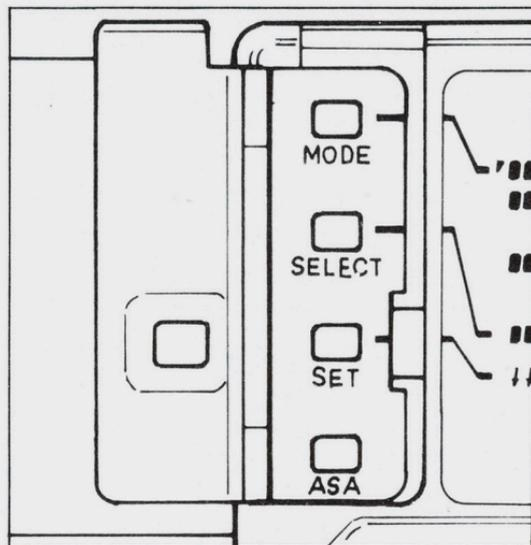
Die Aufzeichnungs-Betriebsart wird mit Hilfe des Betriebsartenknopfes "MODE" ein- und ausgeschaltet, während die Einstellung von Datum und Uhrzeit mit Hilfe der Wähl- und Einstellknöpfe "SELECT" und "SET" erfolgt. Der "ASA"-Knopf dient zur Wahl des Belichtungsmaßes für die Aufzeichnung auf den Film. Der Steuerknopfdeckel kann durch Hochheben am oberen Ende mit dem Fingernagel geöffnet werden.
