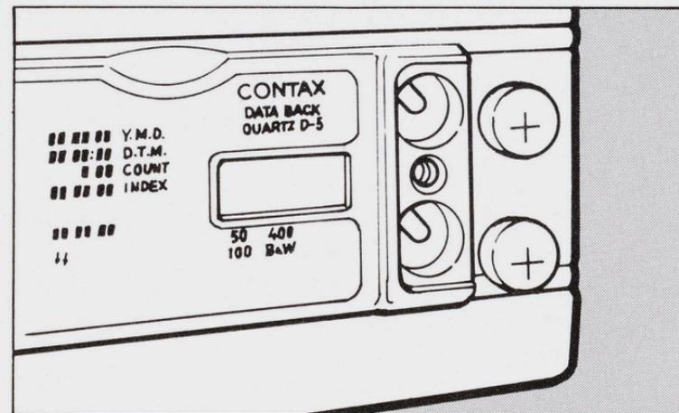
Nachdem die Batterien eingesetzt worden sind, zeigt das Anzeigefenster das Datum 1. Januar 1981 (**'81 1 1**) an. Diese Anzeige ist gemäß den Anweisungen zur Einstellung von Datum und Uhrzeit auf Seite 37 auf das gegenwärtige Datum und die Uhrzeit zu ändern.
