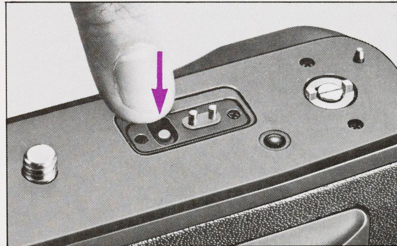
**3** Das Batteriemagazin wieder in den Motoraufzug einsetzen. Drücken Sie das Magazin sorgfältig bis zum Einrasten des Verschlusses ein. (Das Magazin kann von beiden Seiten her eingeschoben werden, vorausgesetzt, daß die Verschlußknöpfe horizontal parallel bleiben.)
