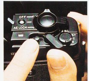
Der Entriegelungsknopf zur Filmrückspulung. Die Lage an der rechten Camera-Oberseite kommt der bequemeren Handhabung entgegen. Um eine unbeabsichtigte Betätigung zu vermeiden, befindet sich der Entriegelungsknopf unter einer schwenkbaren Abdeckklappe.
