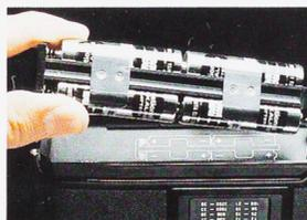
magazin verwendet, ein Reservemagazin kann rasch gegen verbrauchte Batterien ausgetauscht werden, das umständliche Batterieeinlegen entfällt. Ein Satz frischer Batterien reicht für ca. 50 Filme à 36 Aufnahmen. Wiederaufladbare NC-Akkus können selbstverständlich ebenfalls verwendet werden.
