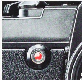
ter sichtbar. Zwei Sekunden vor der Verschlussauslösung erhöht sich zur Warnung die Blinkfrequenz. Als Stromquelle dienen der Contax 137 MD Quartz vier 1,5 V-Mignonbatterien. Damit werden die Camera-Elektronik selbst und der motorische Filmtransport gespeist. Zum Einlegen wird ein spezielles Batterie-
