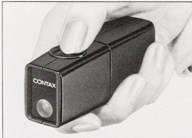
Es ist eine Anzahl von Leeraufnahmen zu machen, bevor Sie den Film laden, um festzustellen, ob das Infrarot-Steuergerät richtig arbeitet.
